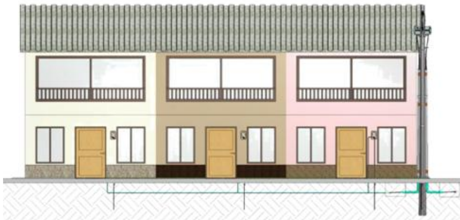
Figura 7. Canalizaciones subterráneas – Acometida subterránea.
